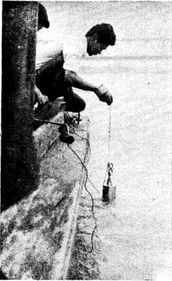
← การเก็บตัวอย่างน้ำในแม่น้ำเจ้าพระยา โดยใช้ D.O. sampler ที่สะพานพระราม ๖ เมื่อเดือนกุมภาพันธ์ ๒๕๑๑
